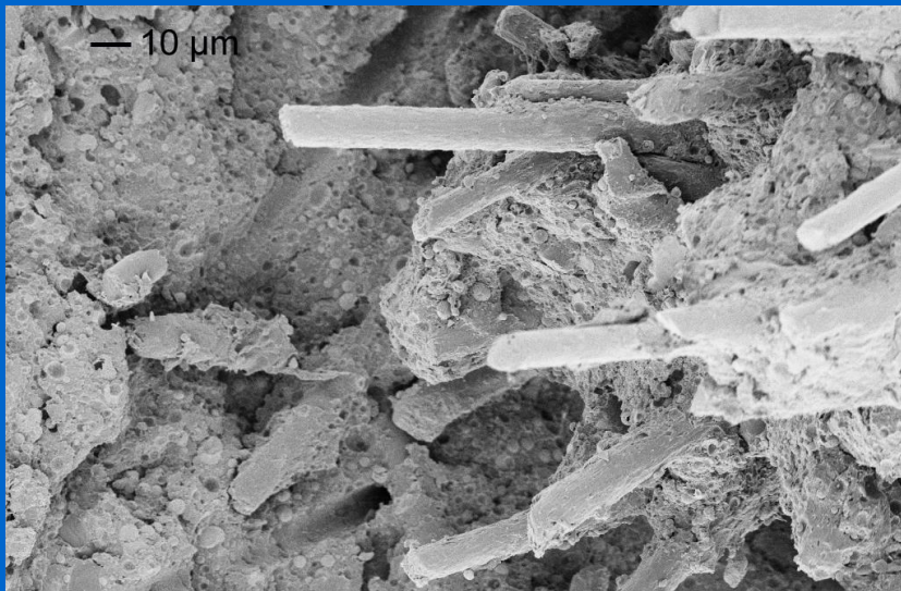
Bruchfläche eines kommerziellen 30 % glasfaserverstärkten PA 4.6 - Produktes
